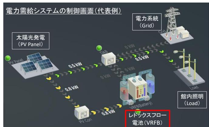
「レドックスフロー電池」は、リチウムイオン電池とは異なる原理により、電池反応に関する部材の劣化がないため、充電や放電を繰り返しても長寿命であり、不燃性の材料によって電池が構成されているので、爆発や発火といった現象が起こらないため、安全性にも優れた特長があります。
